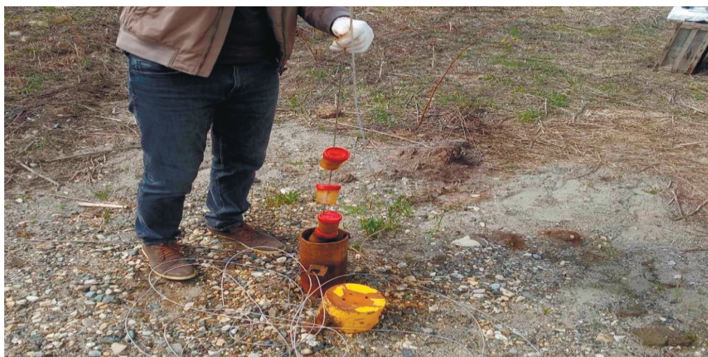
Рис. 2. Проведение полевых исследований скорости растворения карбонатных пород в районе г. Перми
