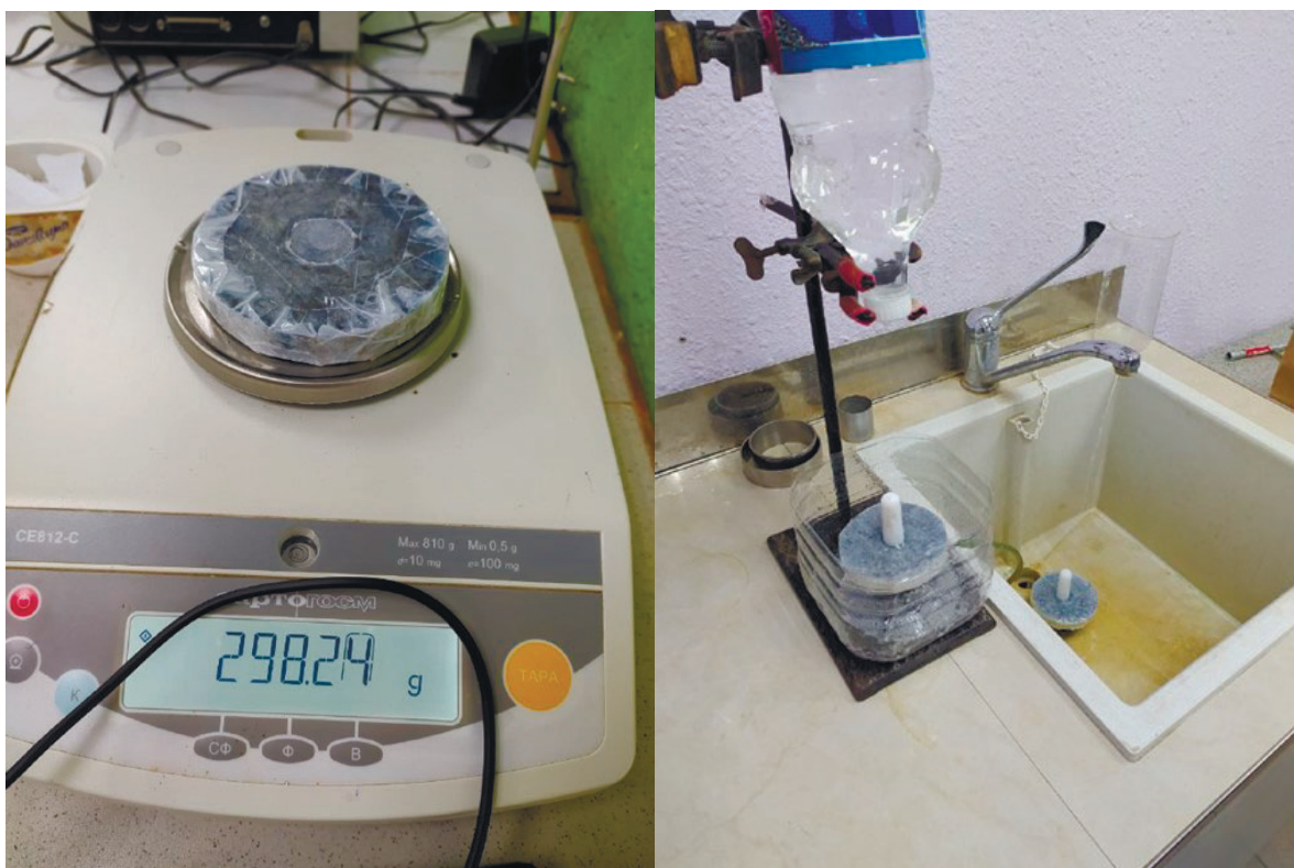
Рис. 1. Образец растворимой породы – слева; Стенд по растворению породы – справа
